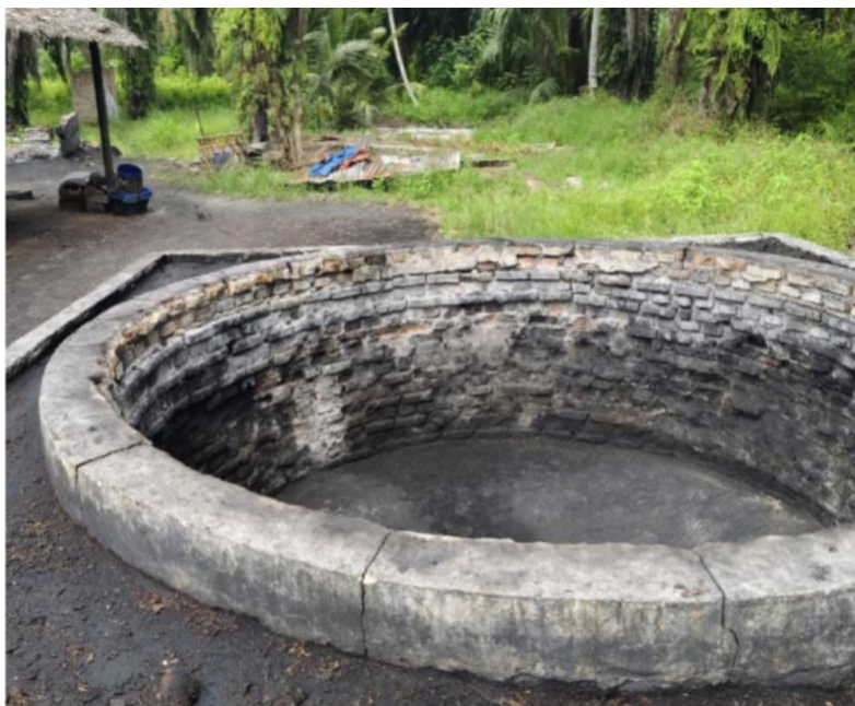
Gambar 2. Wadah Tempat Pembakaran Batok Kelapa menjadi arang
