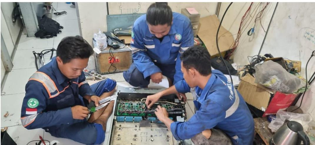
Gambar 3. Peserta melakukan pemasangan IGBT secara mandiri
