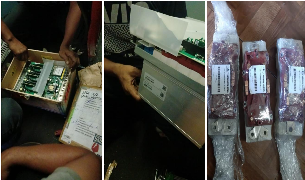
Gambar 2. Peserta melakukan Penggantian komponen elektronika daya (IGBT) yang rusak dengan komponen elektronika daya (IGBT) yang baru
