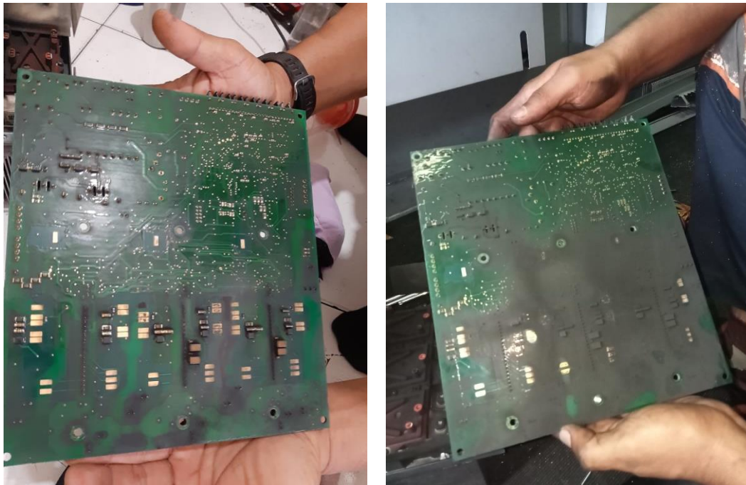
Gambar 1. Peserta membongkar bagian yang mengalami kerusakan pada Inverter pengatur kecepatan motor
