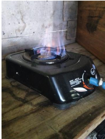
Gambar 5. Hasil api biodigester pada kompor gas
