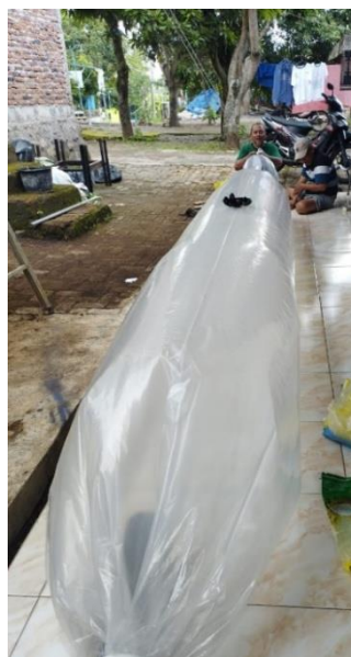
Gambar 3. Bak penampungan Biogas digester dalam media plastik Polyethylene (PE)
