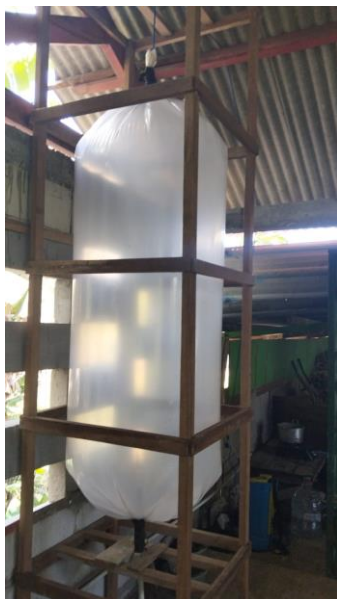
Gambar 3. Pembuatan tabung gas dari plastik Polyethylene (PE)
